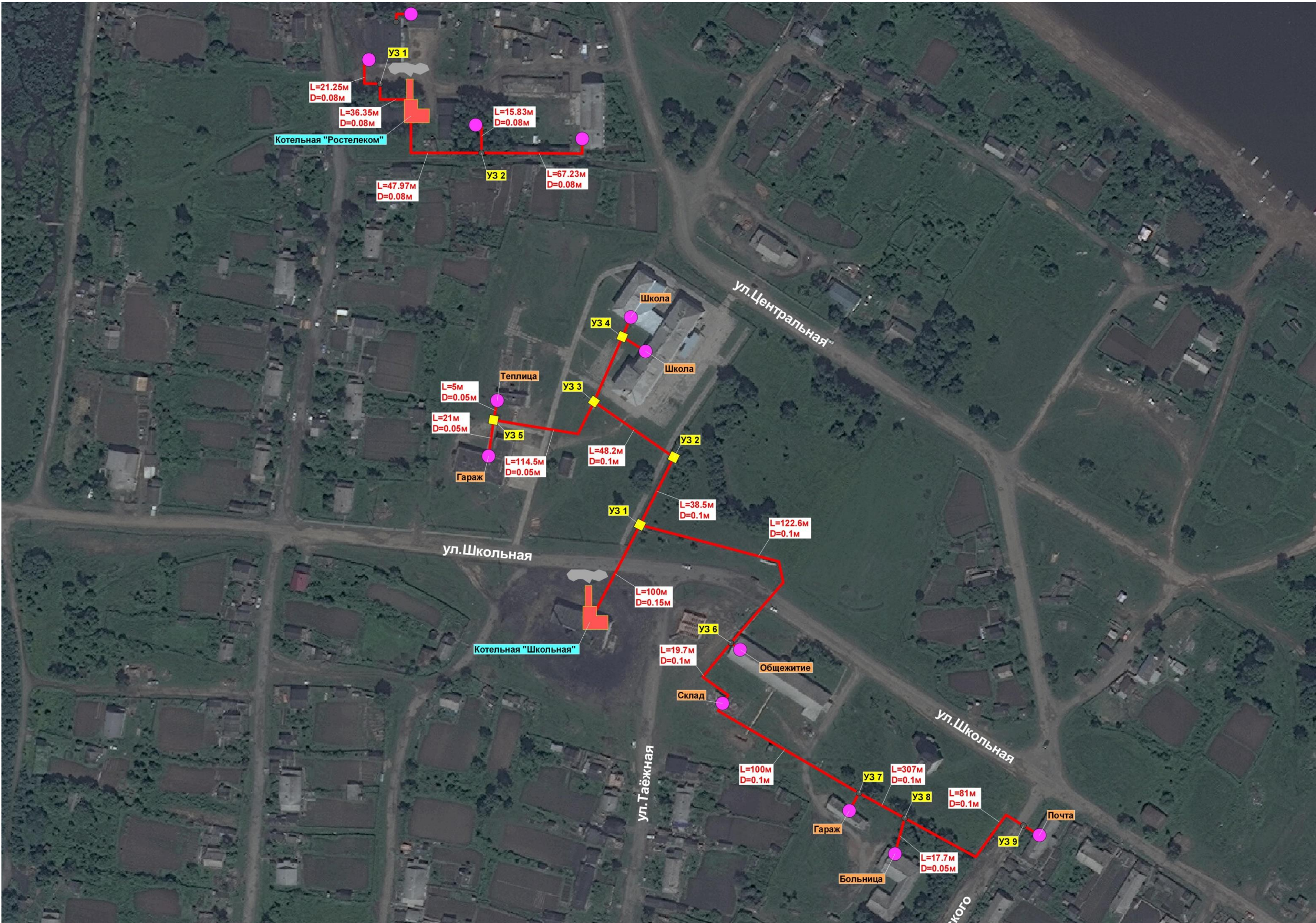
Рис. 1.4 – Схема теплоснабжения муниципального образования «Село Софийск» от котельной «Школьная» и «Ростелеком»
